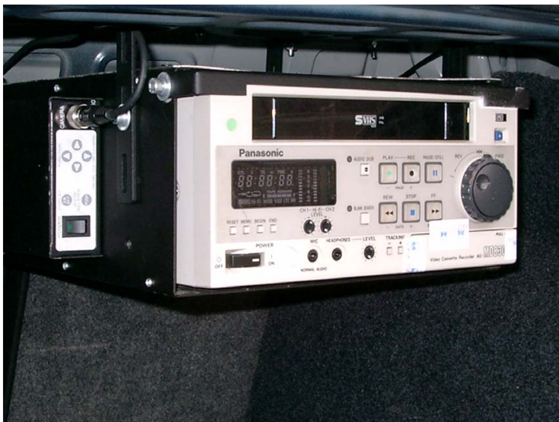
SLIKA 2: Osrednja enota videonadzornega sistema PROVIDA
