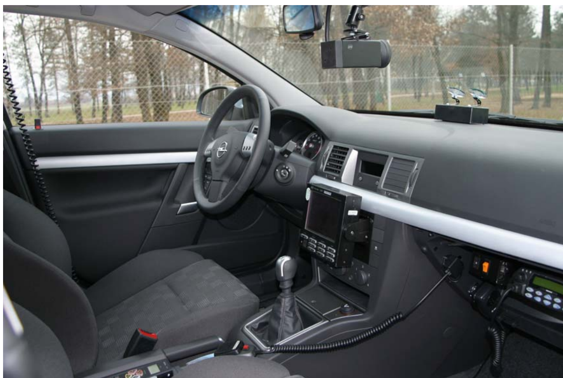
SLIKA 1: LCD prikazovalnik, PolicePilot in kamera sistema PROVIDA
