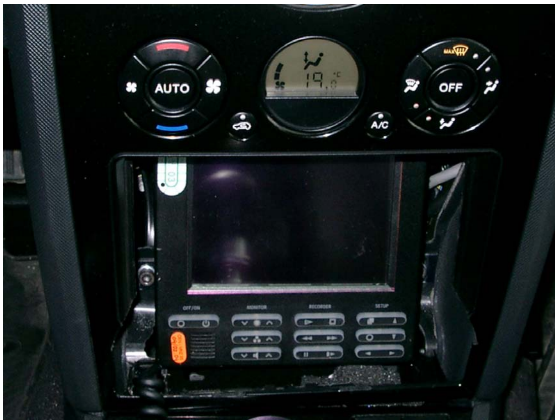
SLIKA 4: LCD prikazovalnik, ki policistu v avtomobilu posreduje vse potrebne podatke
