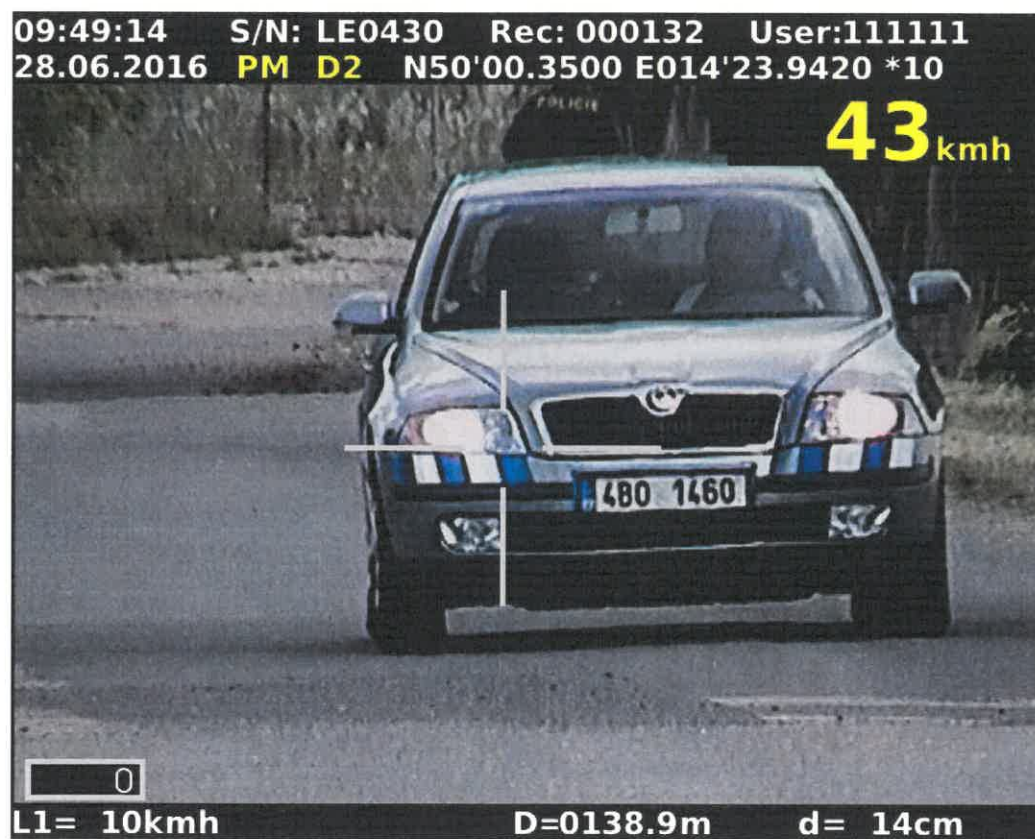
Obr. 8 Příklad snímku při měření rychlosti na příjezdu
