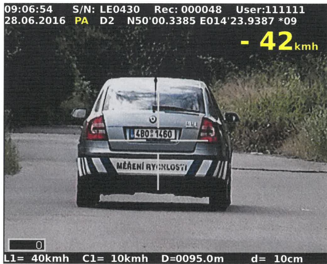
Obr. 9 Příklad snímku při měření rychlosti na odjezdu
